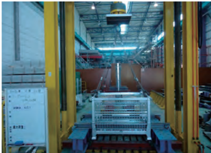
平均破壊荷重82.9KN 安全率5以上
